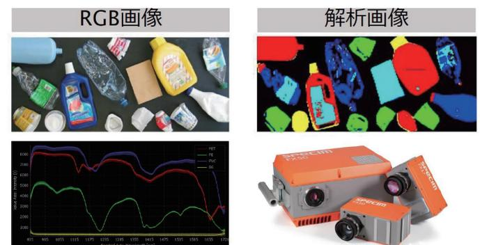
図3 ハイパースペクトルカメラによる樹脂の識別・分類
