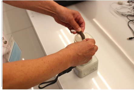
図4 カラートリートメントで染色した毛束のCM-700dによる測定風景
