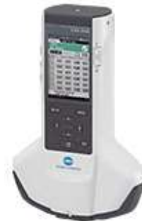
図9 色と光沢の測定が同時にできる分光測色計「CM-36dG」
