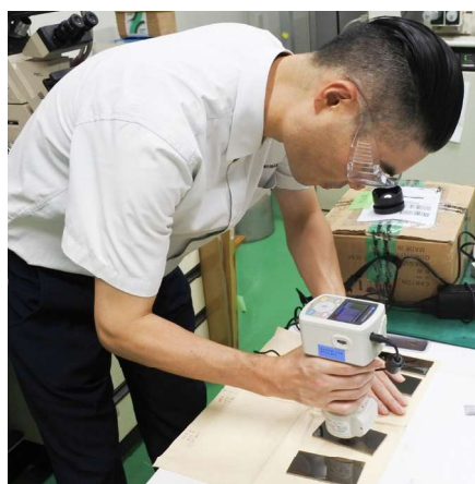
図2 分光測色計を用いた装飾めっきの品質管理
