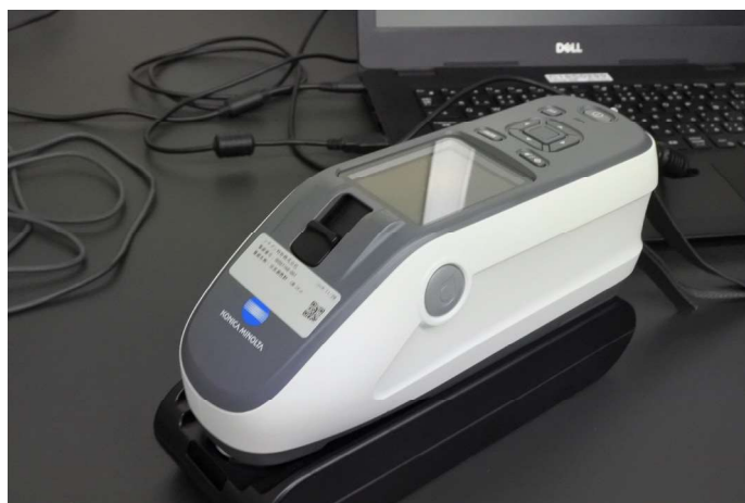
図5 DLCコーティングの色調の評価に使われている分光測色計「CM-26d」
