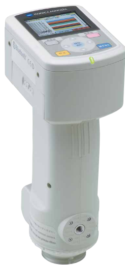
カラー液晶・ワイヤレス通信、小型・軽量で機動性・操作性に優れた分光測色計CM-700d
