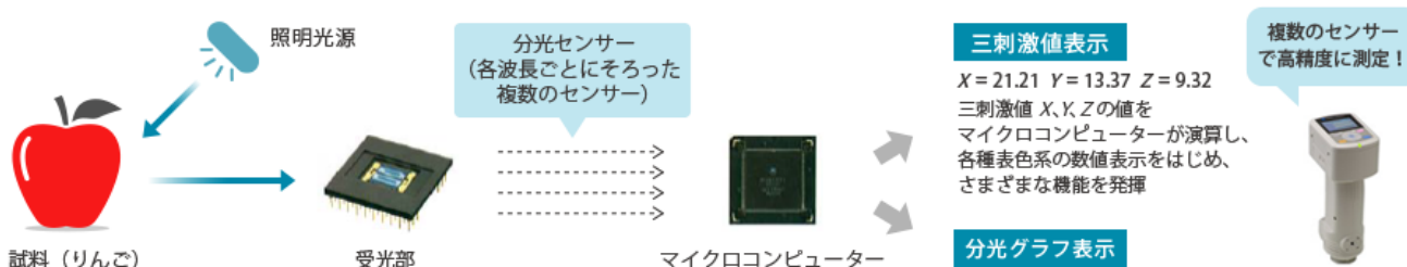
図3 分光測色計の原理
