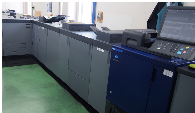
C4080+TU-510のユニットで、印刷から加工までがインラインで実現
