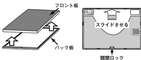
**注意**：マンモ用 RM カセットの開閉ロックを閉めるときは、バック板をフロント板の奥にぶつかるまでスライドさせてから、開閉ロックを閉めること。
