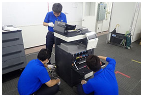
コニカミノルタ製複合機の清掃作業（エンジニアリンググループ）
